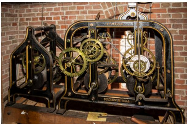
Ein Stockwerk über der Orgelempore im Turm befindet sich die Uhr. Herzstück ist das Uhrwerk der Firma Weule, welches im Zuge der Erbauung des heutigen Turmes 1894 für unsere Gemeinde gefertigt wurde. Ein Gestänge leitet die Bewegung der Uhr bei dieser Konstruktion zunächst an den
